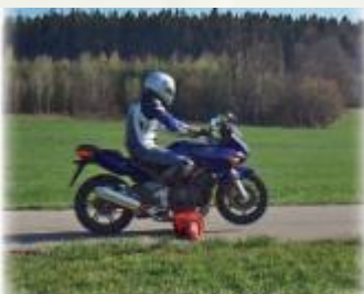
Kreiselmoment stabilisiert das Motorrad
