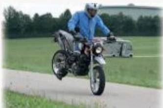
Schwerpunktlage beeinflusst das Bremsverhalten
